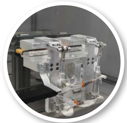
POSIZIONAMENTO, BLOCCO MATERIALE E TRASPORTO DEL MANICO
