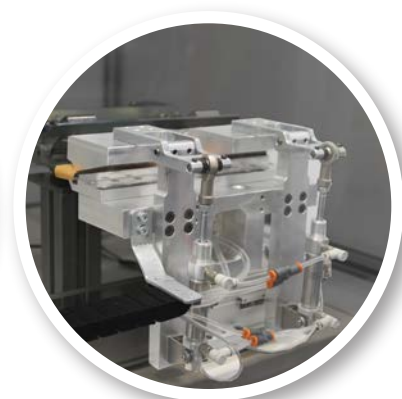
POSIZIONAMENTO, BLOCCO MATERIALE E TRASPORTO DEL MANICO
